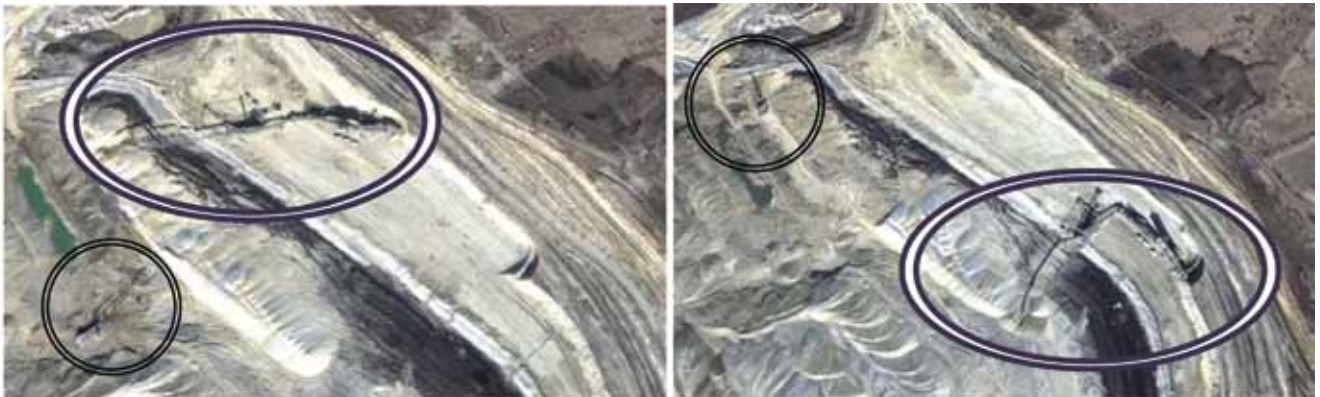
Рис. 3. Фрагмент космоснимка роторного экскаватора CRS(k)-4000 с отвалообразователем на отработке вскрышного уступа (разница в положении – 10 дней)
