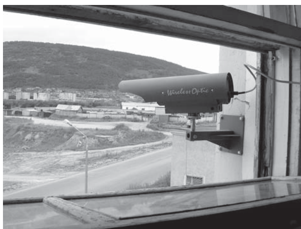
Рис. 7. Беспроводный оптический канал связи БОКС (FSO) между сетями Северо-Восточного КНИИ и Института биологических проблем Севера в Магадане
