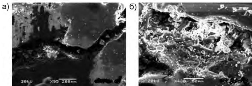
Рис. 2. Вид фрагмента трещины после взрыва непосредственно вблизи зарядной полости при увеличении 95<sup>х</sup> (а) и 430<sup>х</sup> (б)
