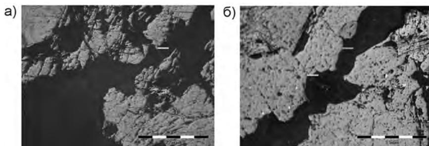
*Рис. 1. Вид отдельных фрагментов трещины непосредственно вблизи зарядной полости (а) и на некотором удалении от нее (б)*
