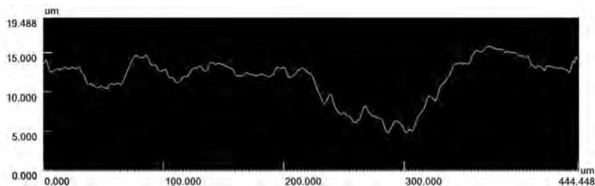
Рис. 3. Распределение значений глубины трещины по данным лазерной микроскопии
