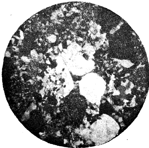
Рис. 6. Грубозернистая структура кварцевого песчаника кровли пласта Характерного. Шахта им. М. И. Калинина. Цемент кремнисто- карбонатный. Ув. 24. Ник. X
