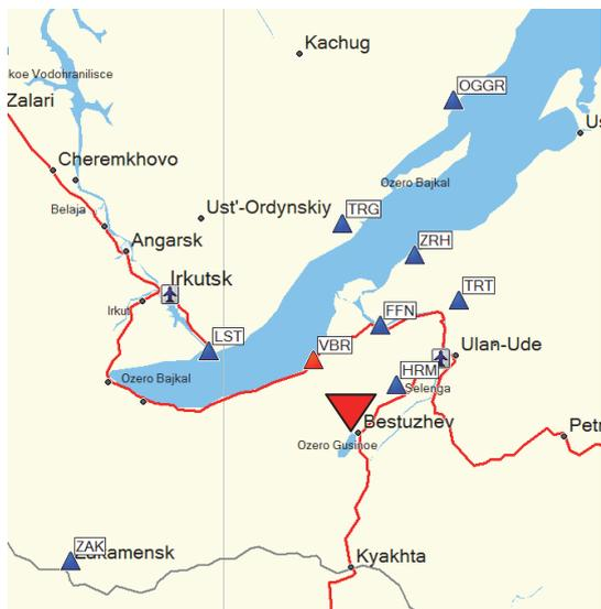
Рис. 1. Система вибросейсмического мониторинга южного Прибайкалья. Красный треугольник – вибратор ЦВО-100 Южнобайкальского полигона, синие треугольники – сейсмические станции региональной сети
