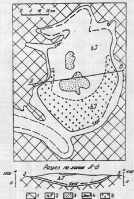
Рис.1. Схема геологического строения Улугхемского бассейна Обозначения: 1 - палеозойский фундамент; 2 - угленосные ранне-среднеюрские отложения; 3 - безугольные позднеюрские -раннемеловые (?) отложения бомской свиты; 4 - выход пласта Улуг под четвертичные отложения; 5 - территория, охваченная поисково-разведочными работами
