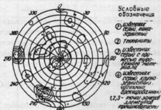
Рис. 2. Характер трещиноватости пород по данным замеров в шурфах
