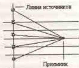
Рис.2. Направление прихода отраженных волн в точку приема при 3D-работах
