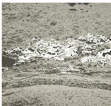
Рис. 6. Линза гематита (белое поле), отороченная лимонитом (темно-серые выделения). Полированный шлиф. Увеличение 40×
