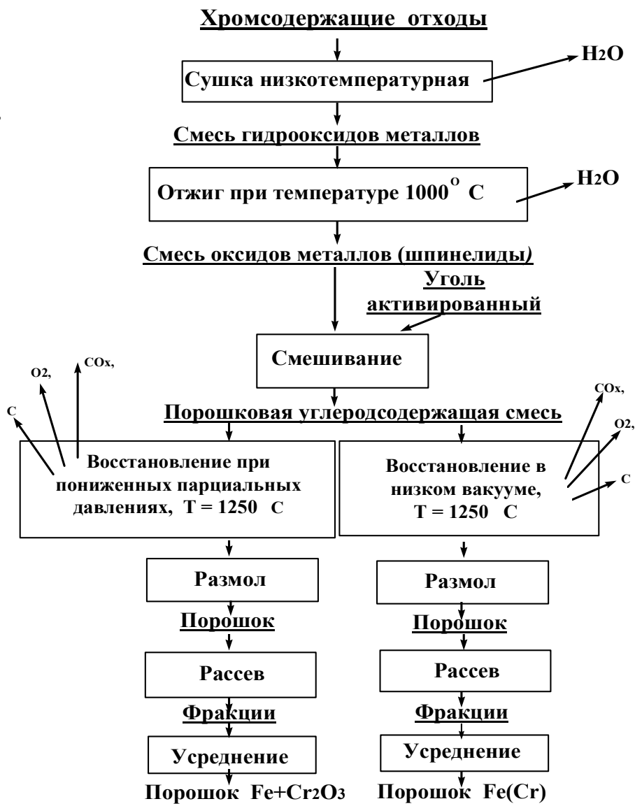
Рис. 5. Технологическая схема рециклинга ХСО
