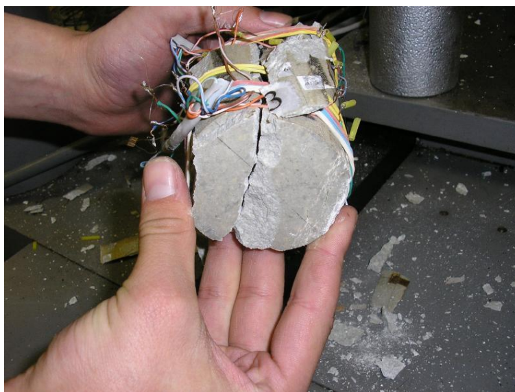
Рис. 9. Характер разрушения образца дацита (№ 3)
