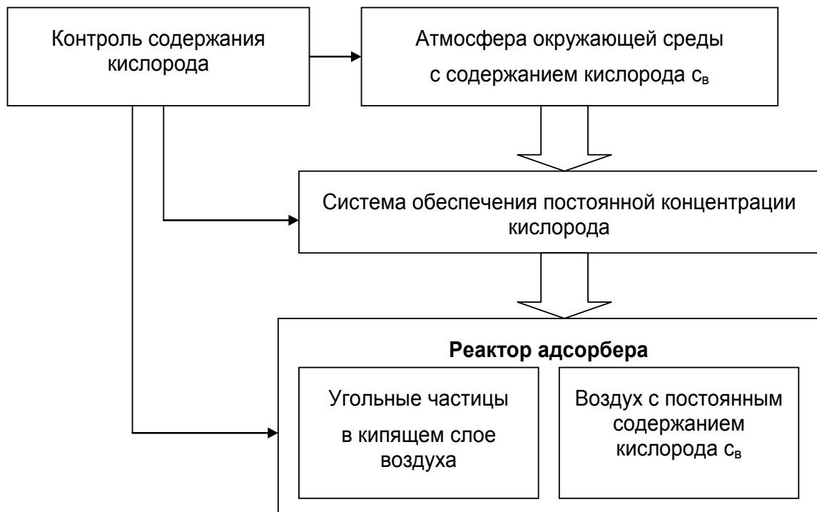
Рис. 1. Технологическая схема лабораторных исследований процесса диффузии кислорода в сферическую угольную частицу в адсорбере открытого типа
