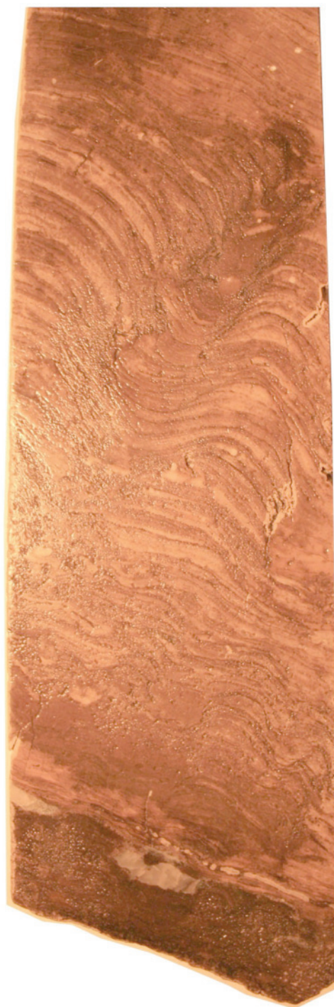
Рис. 4. Строматолитовый доломит. Образец керна: Берямбинское ГКМ, скв. 1, нижнебельская подсвита нижнего кембрия, продуктивный пласт А-V-III
