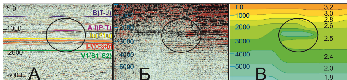
Рис. 8. А – фрагмент временного разреза по HZ компонентам по профилю № 7-2016 (PP-волны); Б – фрагмент временного разреза по R(X) компоненте (PS-волны); В – фрагмент разреза отношения V_p/V_s (ОАО «МАГЭ», 2016, Печорское море)
