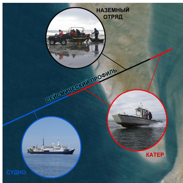
Рис. 1. Пример перехода от глубоководных участков через мелководную зону на сушу
