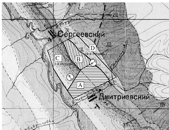
Рис. 5. Разработка участка Дмитриевского месторождения открытым способом
