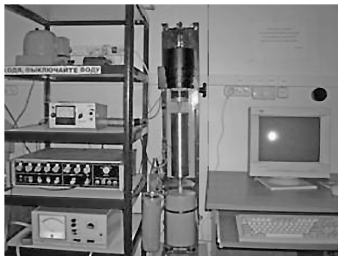
Рис. 6. Вибрационный термомагнитометр ВМА-1 для исследования магнитных свойств пород и минералов в диапазоне температур от 20 до 700^\circ\text{C}
