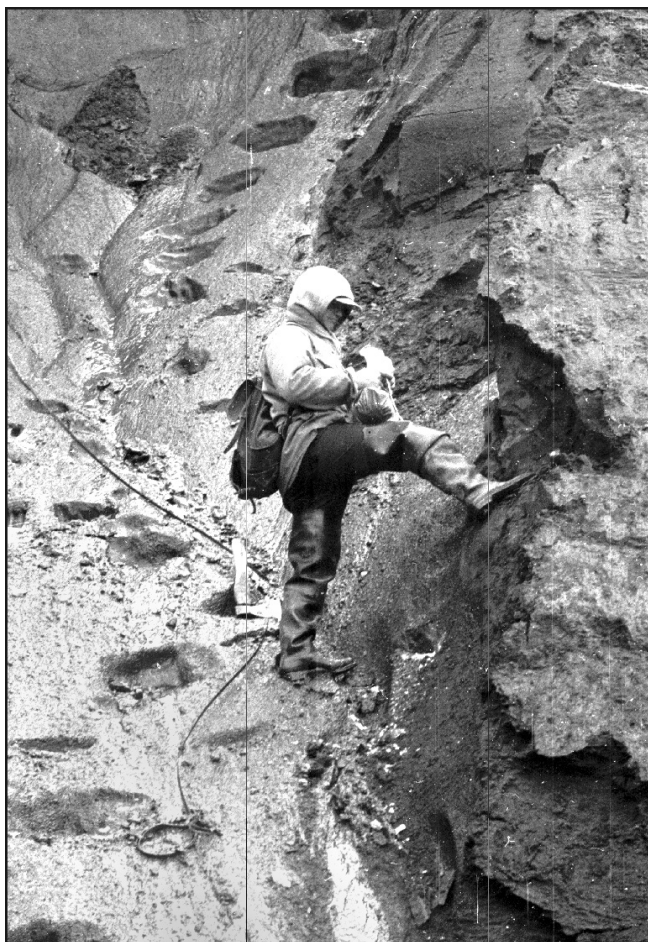
Рис. 2. Отбор образцов для изотопно-геохимических определений из позднеплейстоценовой сингенетической ледяной жилы Айонской едомы. Фото Ю.К. Васильчука
