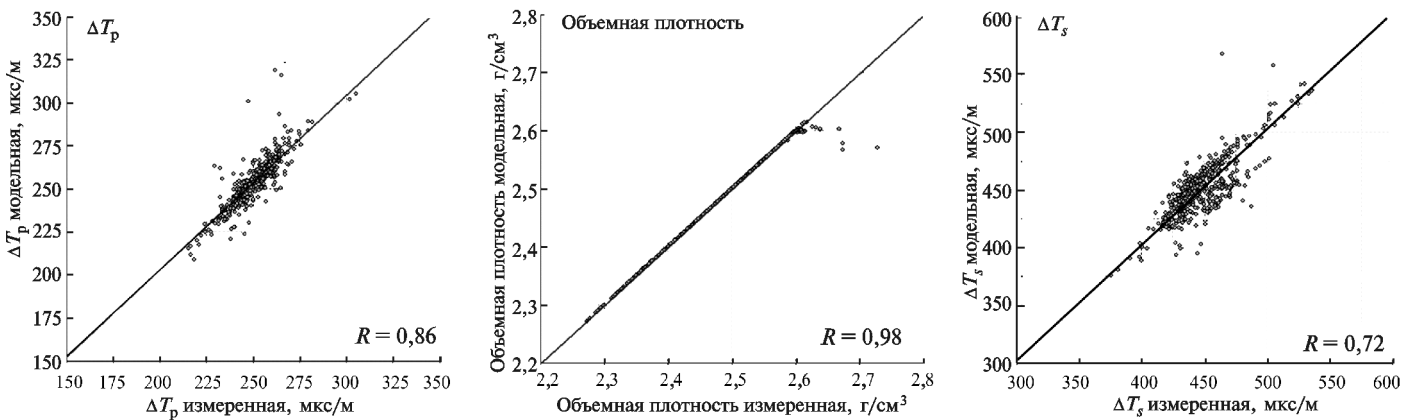
Рис. 3. Сопоставление измеренной и модельной кривых упругих свойств в скважине 1
