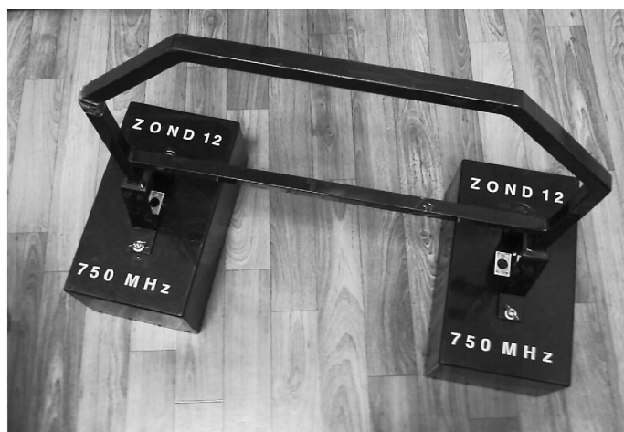
Рис. 1. Раздельная антенная система 750 МГц георадара «Zond 12-C»
