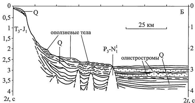
Рис. 4. Строение осадочной толщи континентального склона и Ялтинского глубоководного конуса выноса (см. рис. 1, профиль Б). T<sub>3</sub>-J<sub>1</sub> — таврическая серия; P<sub>3</sub>-N<sub>1</sub><sup>1</sup> — майкопская серия; Q — плейстоцен
