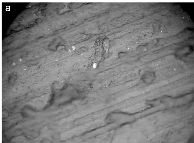
Рис. 1. Уголь полуматовый тонко-коротко-штриховатый черного цвета (Ургальское каменноугольное месторождение, образец N15) при пятисоткратном увеличении: а – включения пирита; б – включения магнетита.
