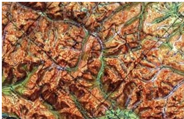
Рис. 2. Сочетание нескольких способов изображения рельефа: горизонталей, гипсометрической окраски, отмывки
