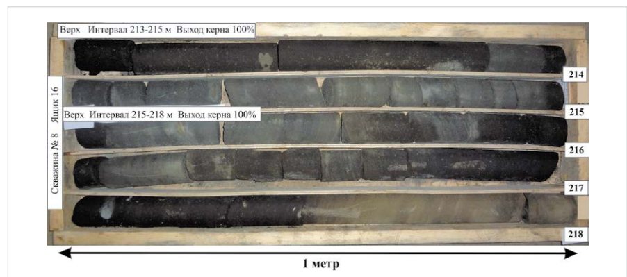
Рис. 4 — Фотография ящика керна №16 скв. №8 (интервал отбора 213–218 м). На фото — битуминозные песчаники уфимского возраста Fig. 4 — Picture of core box №16 (213–218 m sampling interval). The picture shows the Ufimian bituminous sandstones
