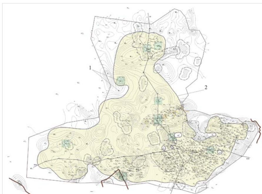
Рис. 6 — Структурная карта по кровле доманиковых отложений (Бавлинское месторождение)
