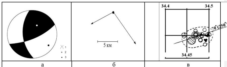
Рис. 1. Стереодиаграмма механизма очага (нижняя полусфера) землетрясения 5 июля 1984 г. в: а – по знакам первых вступлений  $P$ -волн; б – процесс разрывообразования, в – эпицентральная зона первых афтершоков. 1 – нодальные линии; 2, 3 – оси главных напряжений растяжения и сжатия соответственно; зачернена область волн сжатия.
