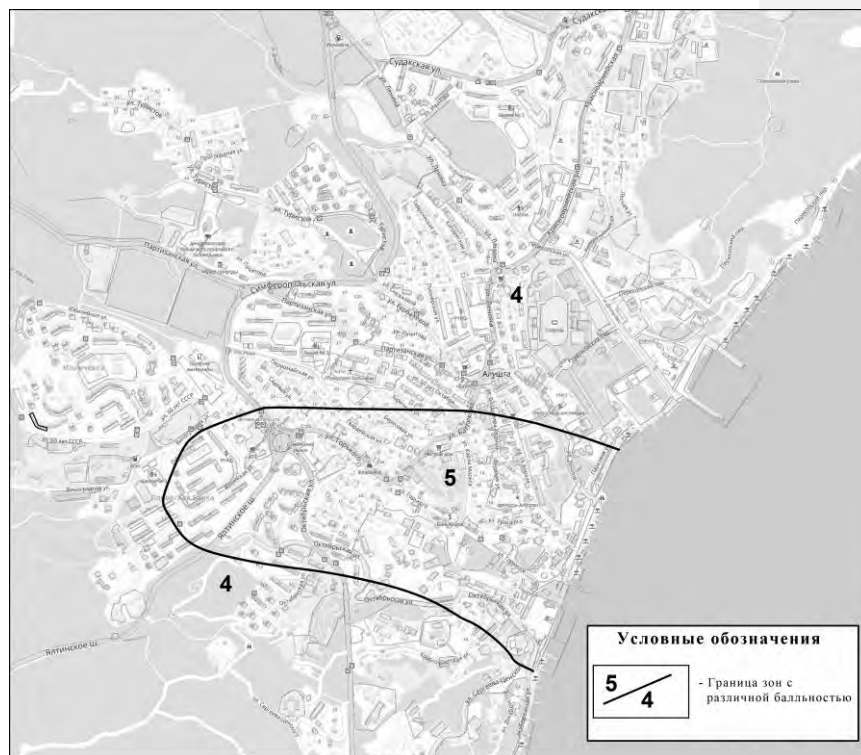
Рис. 2. Схема распределения интенсивности сотрясений при землетрясении 13 мая 2016 г. на территории г. Алушты.
