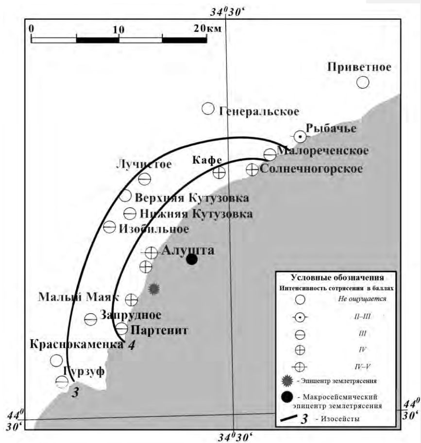
Рис. 1. Схема распределения интенсивности сотрясений при землетрясении 13 мая 2016 г. на территории Южного берега Крыма.
