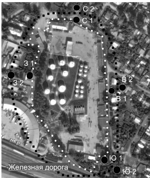
Рис. 1. Схема расположения точек отбора проб вблизи нефтебазы: пунктир светлыми точками – ориентировочная граница СЗЗ; пунктир чёрными квадратами – утверждённая граница СЗЗ; чёрные кружки – точки пробоотбора: С 1, В 1, Ю 1, З 1 – на границе СЗЗ; С 2, В 2, Ю 2, З 2 – в жилой зоне (ЖЗ)
