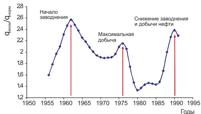
Рис. 1. Динамика отношения средних дебитов аномальных скважин к средним дебитам нормальных скважин Миннибаевской площади за 40 лет их эксплуатации (по данным Хисамов и др., 2012)
