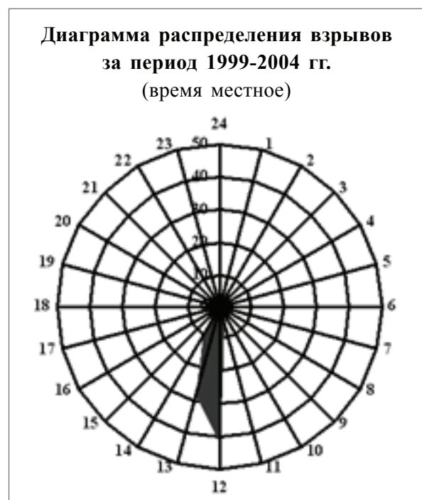
Рис.2. Распределение карьерных взрывов по времени суток
