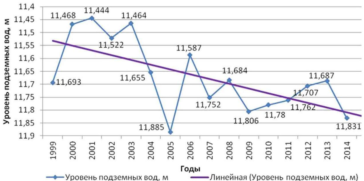
Рис. 2. Среднегодовые значения уровня подземных вод водоносного четвертичного горизонта в скв.959 на участке «Нечаевский» (р.Терешка) в многолетнем разрезе
