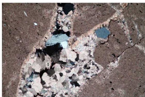
Рис. 19. Известняк КС абалакской свиты с трещиной, залеченной кальцитом (1), ангидритом (2) и кварцем (3)
