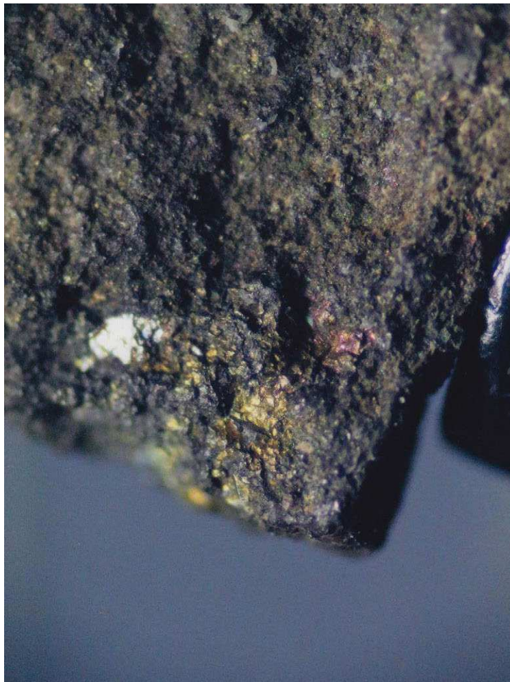
Рис. 2. Выделения сфалерита, халькопирита в сульфидной пиритовой массе
