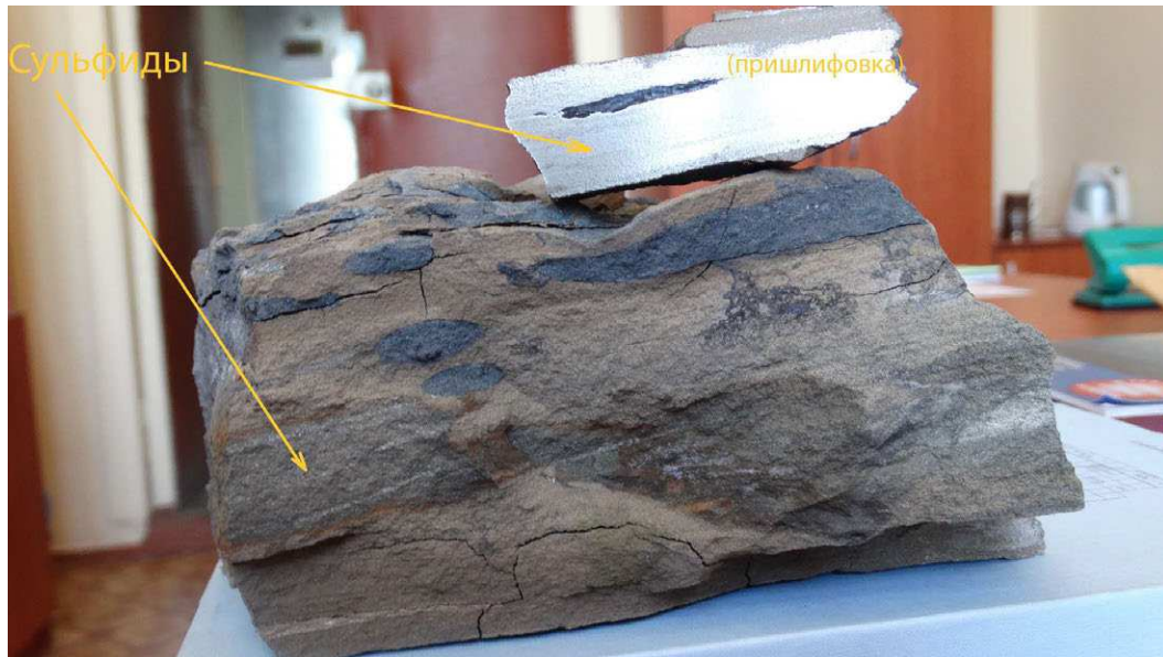
Рис. 1. Пропластки интенсивно сульфидизированных осадочных пород волжских (тигонских) отложений
