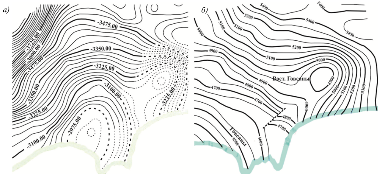
Рис. 8. Структурные карты по данным сейсморазведки 2D (а) и 3D (б)
