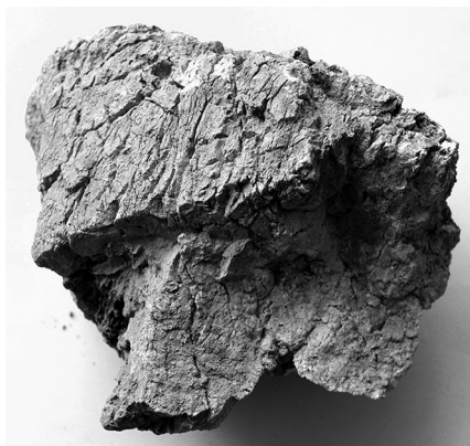
Рис. 7. Лешательерит – ударно-изотропизированный и вспененный кварц. Лёгкая пористая масса светло-бежевого цвета. На поверхности – многочисленные трещины, похожие на трещины дегидратации коллоидов. Размер 15 \times 11 \times 7 см.
