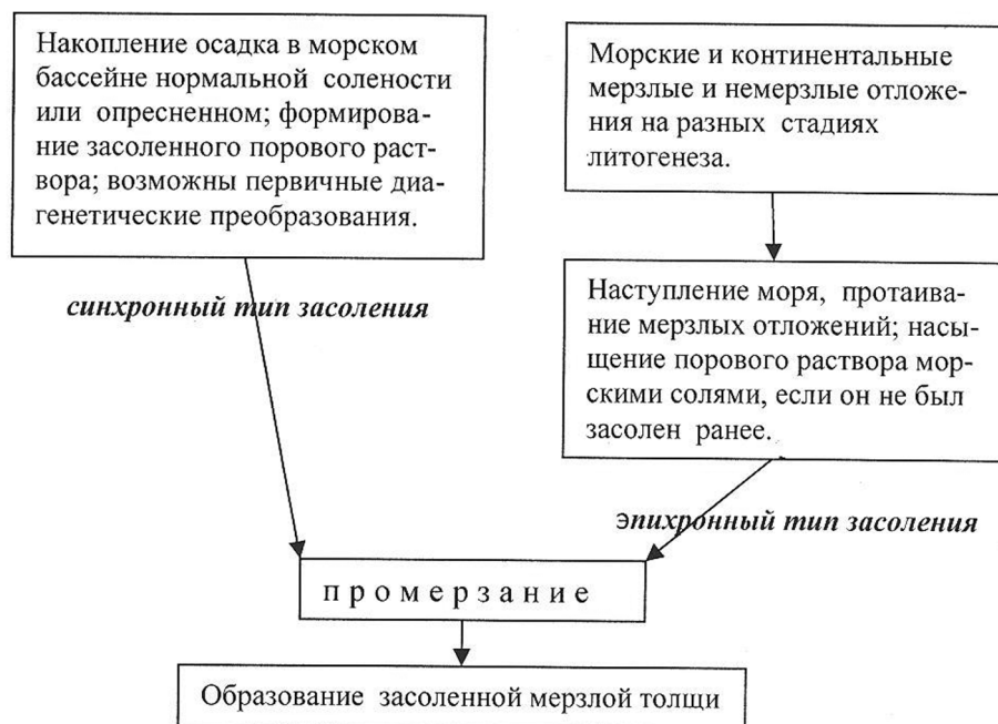
Рис. 1. Основная схема формирования засоленных пород Арктического побережья, по (Брушков, 1998)
