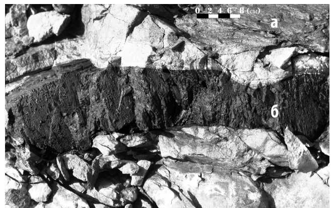
Рис. 4. Жила антраксолита с резкими контактами в аргиллитах. Толщина жилы 6 см
