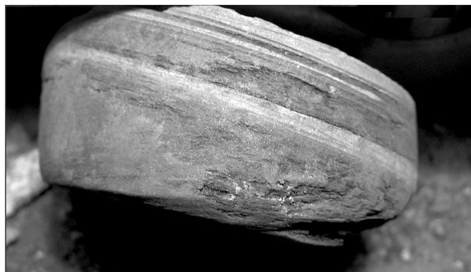
Рис. 8. Фотография ядра скв. 2. Тонкослоистые мелкозернистые песчаники и алевролиты с пологой слоистостью (гл. 82,7 м) \times 3,0
