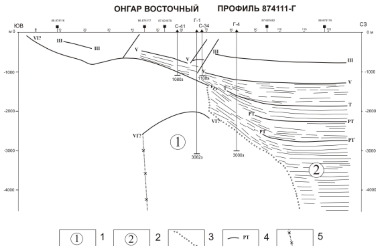
Рис.2. Строение триасовых отложений соляного купола Онгар Восточный по сейсмическим данным. 1 – без отражений, 2 – с отражающими площадками, 3 – граница между разными типами разреза, 4 – основные отражающие горизонты, 5 – крутой склон соли
