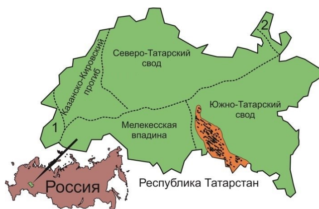
Рис. 1. Область распространения шешминских битумонасыщенных песчаных отложений (поле с черными точками) в пределах Татарстана. Пунктирной линией показаны схематичные границы структурно-тектонических элементов (1 – Токмовский свод, 2 – Верхнекамская впадина)
