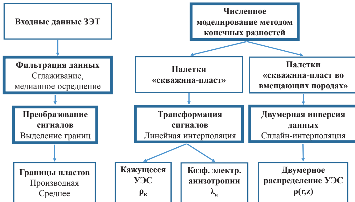
Рис. 4. Блок-схема вычислительных способов обработки и интерпретации результатов измерения ЗЭТ
