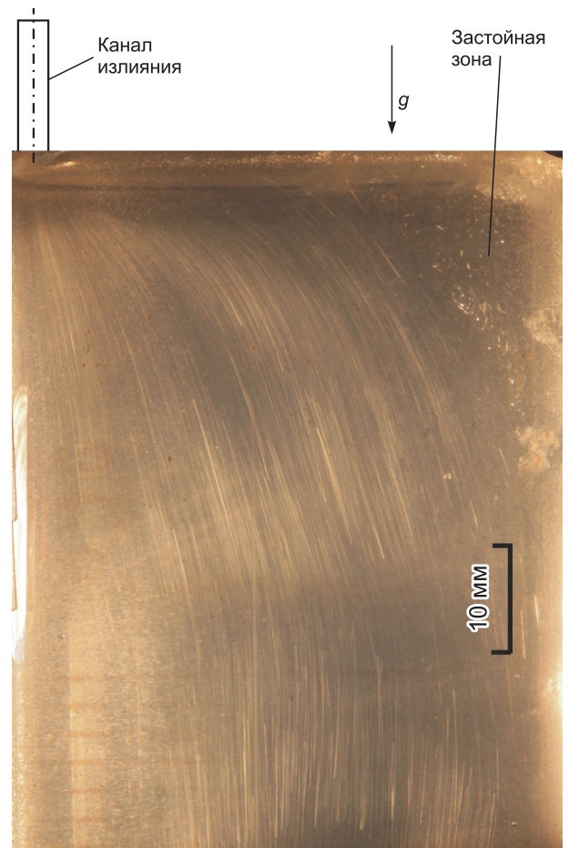
Рис. 9. Фотография картины течения в осевой плоскости. Канал истечения расположен у образующей цилиндра. Re=443 , \bar{u}=8.2 мм/с, время экспозиции 1.6 с.
