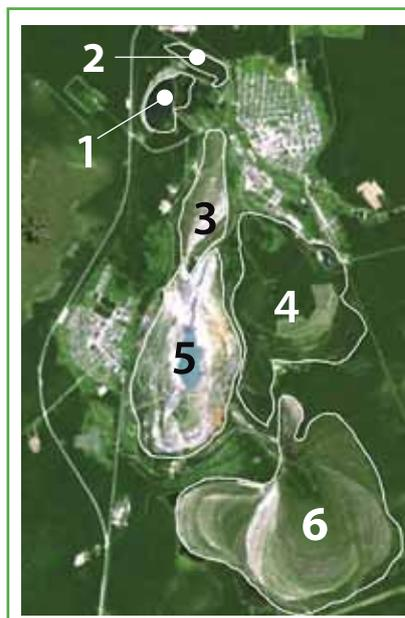
Рис. 1. Фрагмент космоснимка с объектами горнопромышленного ландшафта на Волчанском угольном месторождении, 2018 г.: 1 – карьер, отработанный в 1970 г.; 2 – внешний отвал; 3 – внешний отвал; 4 – внешний отвал; 5 – угольный разрез «Волчанский»; 6 – внешний отвал
