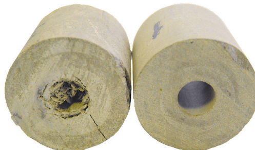
Рис. 12. Внешний вид образца № 1 с внутренним отверстием до (справа) и после (слева) испытаний при увеличении P_{\text{эф}}
