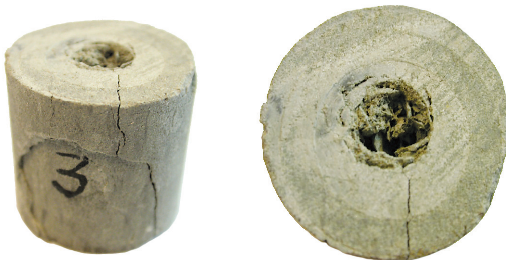
Рис. 13. Внешний вид образца № 3 с внутренним отверстием после испытаний при увеличении P_{эф}
