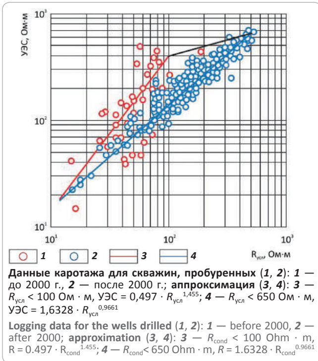
Рис. 6. Зависимость УЭС от условного сопротивления, определенного по данным БК-3 (Астраханское ГКМ) Fig. 6. Resistivity as a function of conventional resistivity determined from LL-3 data (Astrakhansky gas condensate field)
