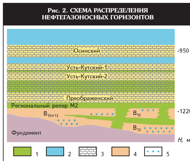
Рис. 2. СХЕМА РАСПРЕДЕЛЕНИЯ НЕФТЕГАЗОНОСНЫХ ГОРИЗОНТОВ 1 – неколлектор; 2 – соль; 3 – карбонаты; 4 – терригенные отложения; 5 – зоны засоления песчаников
