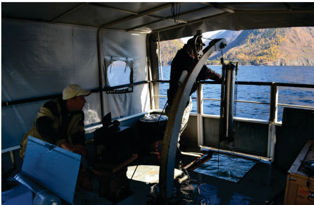
Фото 2. Отбор проб воды батометром с борта судна
