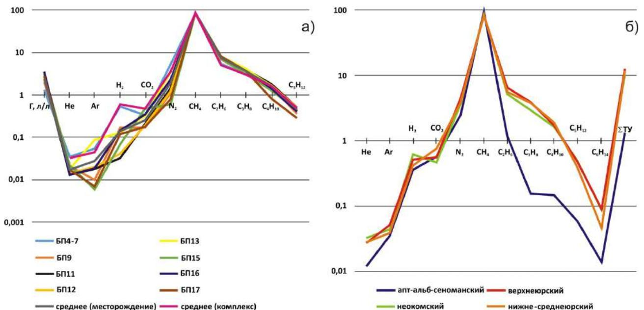
Рис. 2. Средний состав ВРГ неокомского водоносного комплекса Восточно-Таркосалинского нефтегазоконденсатного месторождения (а) и нефтегазоносных комплексов Надым-Тазовского междуречья (б)
