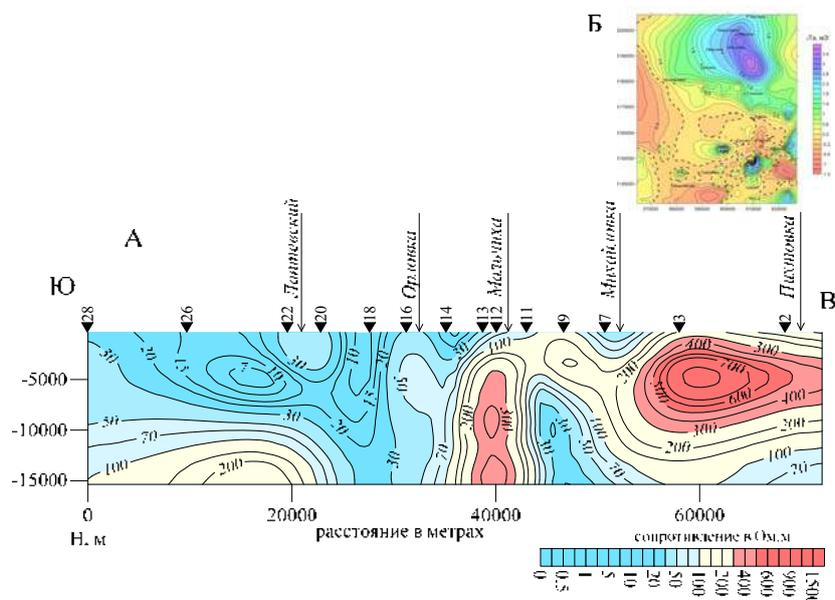
Рис. 3. Глубинный геоэлектрический разрез по профилю п. Пихтовка-п. Половинка (а) и карта магнитных аномалий листа N-44-V (б)
