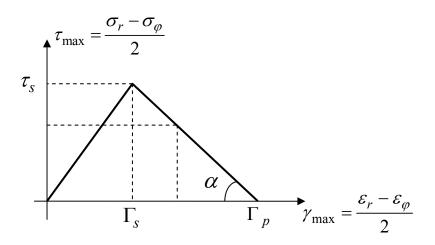
Диаграмма изменения  $au_{\max} = f(\gamma_{\max}),$   $\Gamma_{_S}$  – предел упругости,  $\Gamma_{_P}$  – предел прочности
