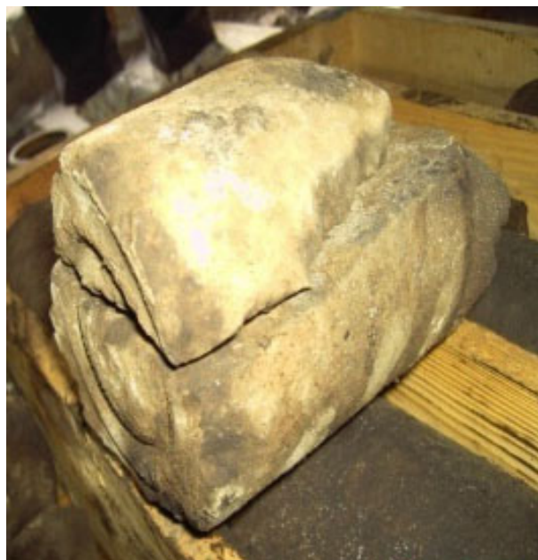
Рис. 4б. Скв. 7159 Матросовское месторождение. В кыновском горизонте аргиллит окварцованный, разбит трещиной под углом 90^\circ , смещение 2м
